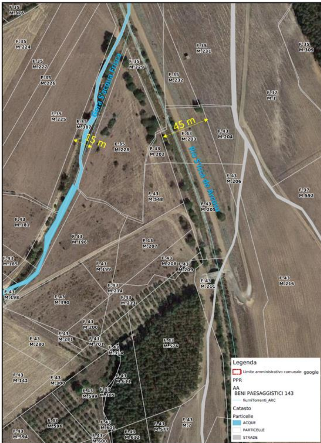
Figura 10 – Rappresentazione delle distanze tra il centro dei corsi d'acqua e le strutture di progetto più prossime (Fonte Geoportale del Comune di Uta con base catastale)
