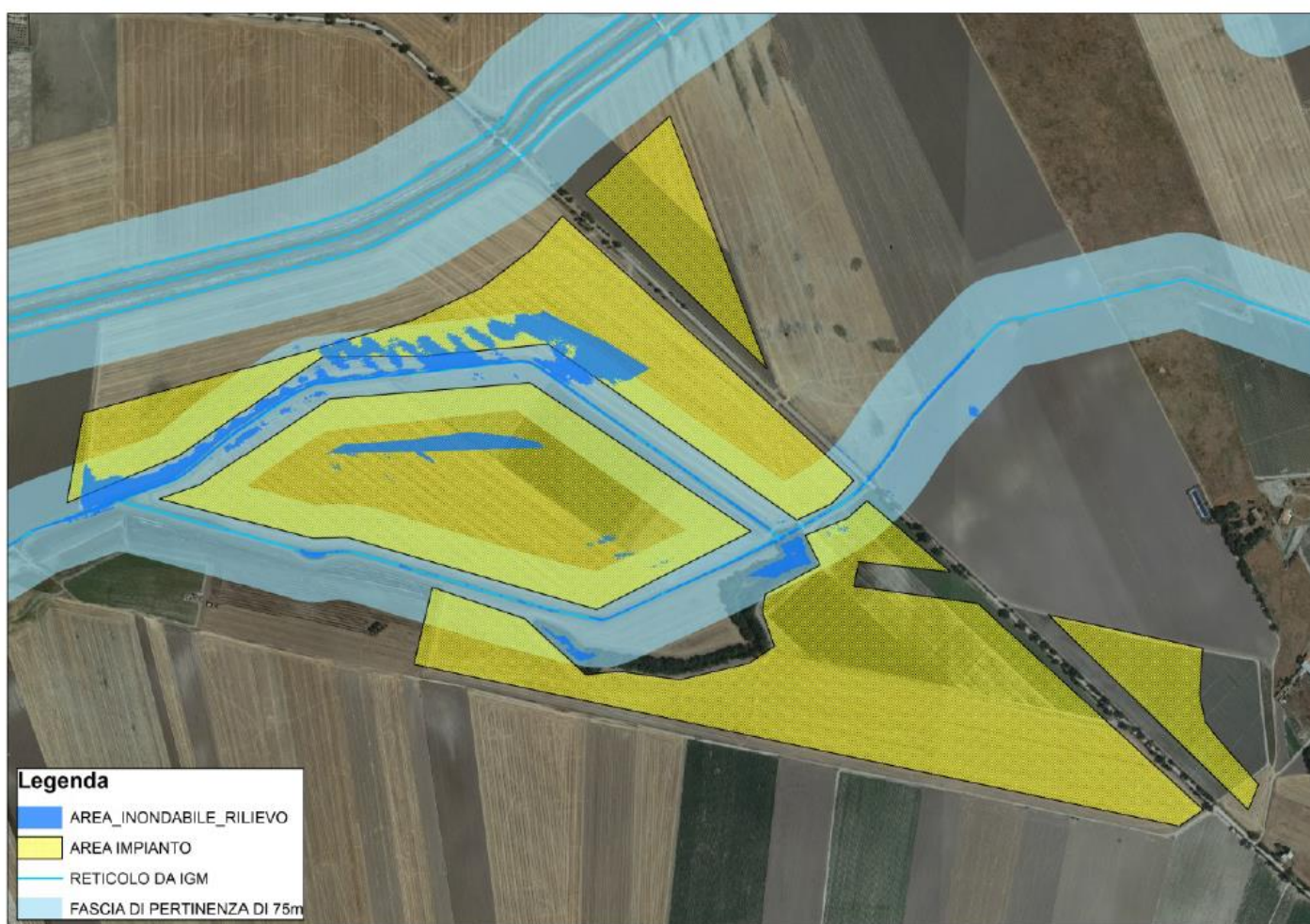
Figure 6: Rapporto del layout di progetto con aree inondabili e fasce di pertinenza
