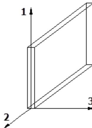
Nel modello di calcolo agli elementi finiti ciascun setto è discretizzato in una serie di elementi tipo "shell" interconnessi; il solutore agli elementi finiti integrato nel programma EdiLus, definisce un riferimento locale per ciascun elemento shell e restituisce i valori delle tensioni esclusivamente rispetto a tali riferimenti.
