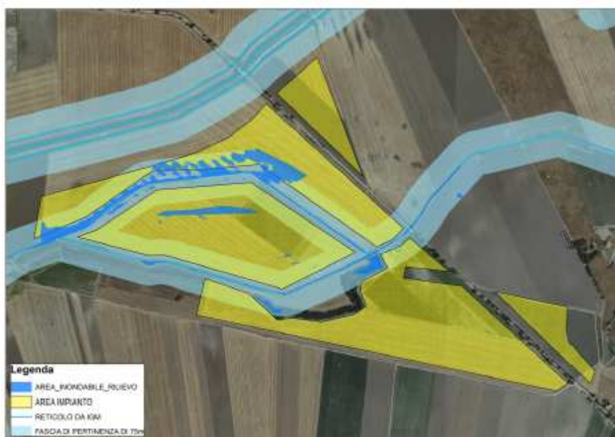
Fig. 13. Rapporto del layout di progetto con AREE INONDABILI e FASCIE DI PERTINENZA
