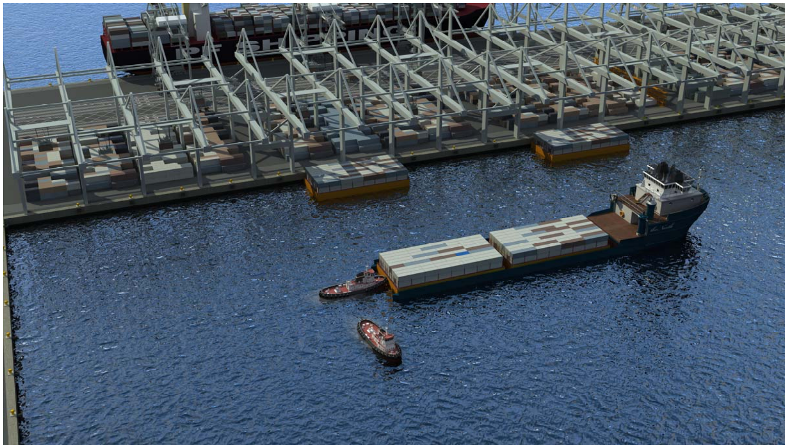
Caricamento delle chiatte su Mama Vessel
