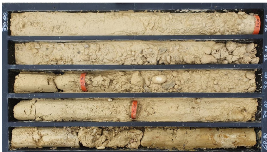
Litofacies ghiaioso-sabbiosa della Formazione del Fosso della Crescenza (FCZ) in corrispondenza del foro di sondaggio S7.
