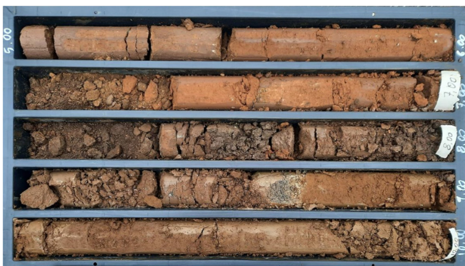
Litofacies cineritico-lapillosa dei Tufi stratificati varicolori di Sacrofano (SKF) in corrispondenza del foro di sondaggio SG5.
