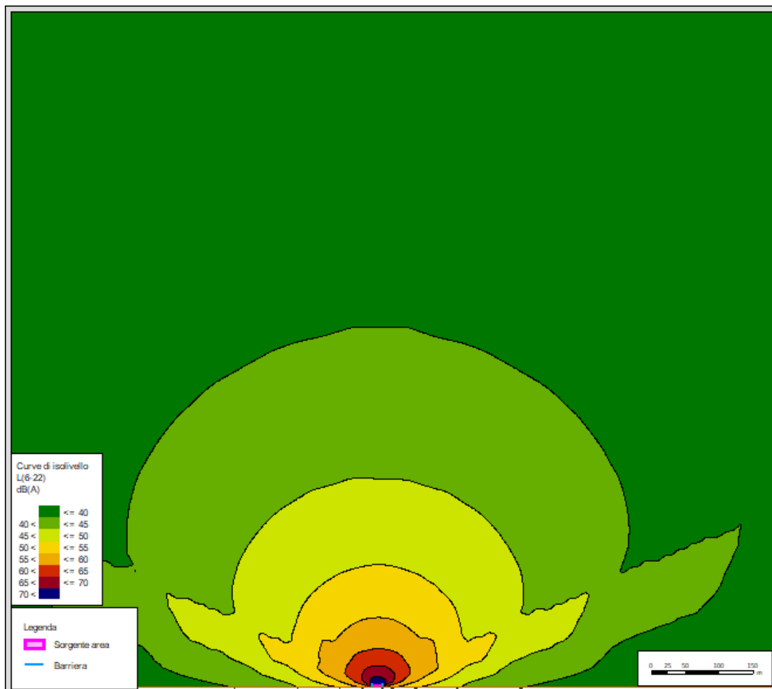
Figura 6-40 Output del modello di simulazione: Mappa in sezione verticale in presenza di barriera
