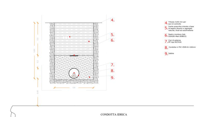
PARTICOLARE INTERSEZIONE TRA CAVIDOTTI BT- MT E TUBAZIONI METALLICHE SU STRADA STERRATA O TERRENO AGRICOLO SCALA 1:10 (QUOTE IN m)
