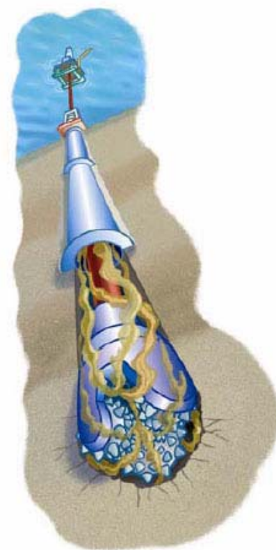
Figura 15 - Schema perforazione e circolazione fanghi
