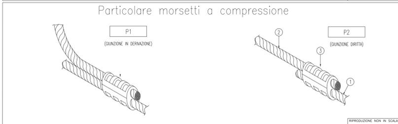
Componenti dell'impianto di terra della cabina di consegna e cabina utente in accordo al progetto di Enel Distribuzione
