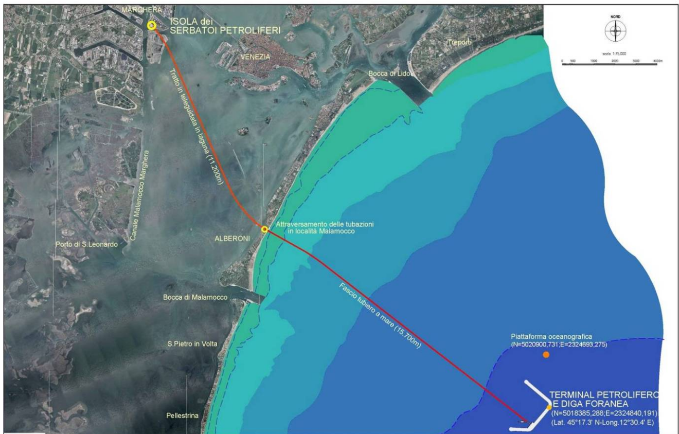
Figura 5.1-11 Terminal petrolifero – percorso delle pipelines.
