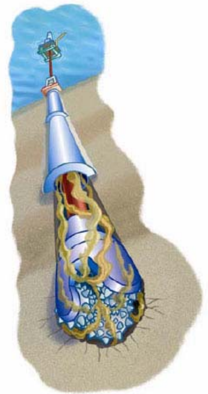
Figura 15 - Schema perforazione e circolazione fanghi
