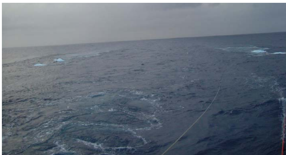
Figura 8 - Effetti in superficie dello scoppio degli air-gun
