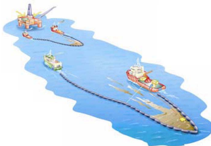
Figura 18 - Sistema di emergenza per la raccolta di oli in mare
