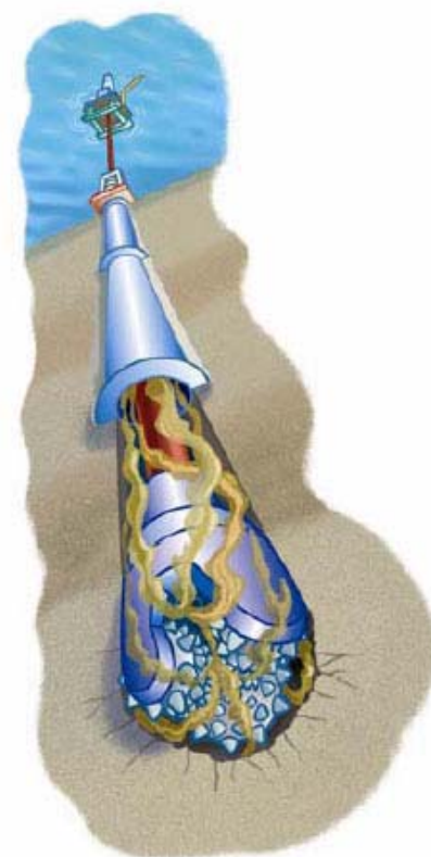
Figura 15 - Schema perforazione e circolazione fanghi
