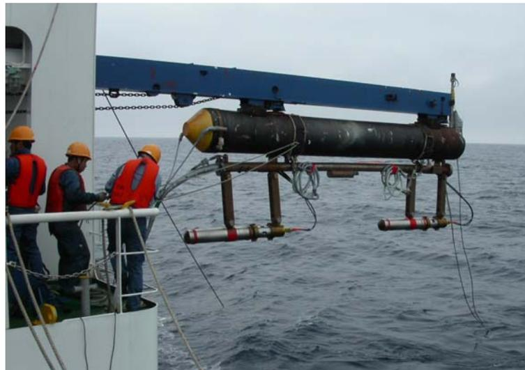
*Figura 7 - Esempio di piccolo array di air-gun*
