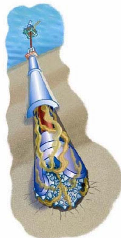
*Figura 15 - Schema perforazione e circolazione fanghi*
