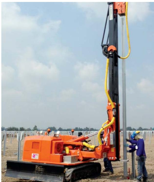
**Fig. 09\_ Esempio di macchina battipalo**
