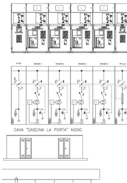
Fig.1.5 _ Cabina dedicata a impianto FV
