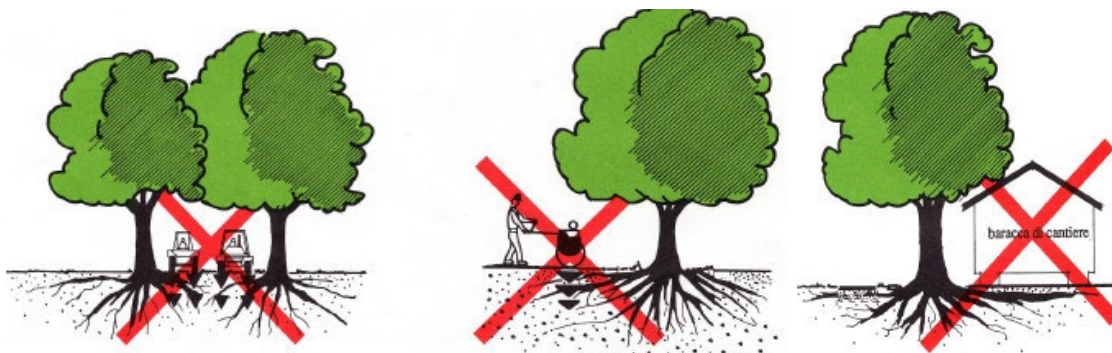
Figura 8-2 Azioni da evitare con mezzi pesanti e d'opera al fine di ridurre il danneggiamento delle radici
