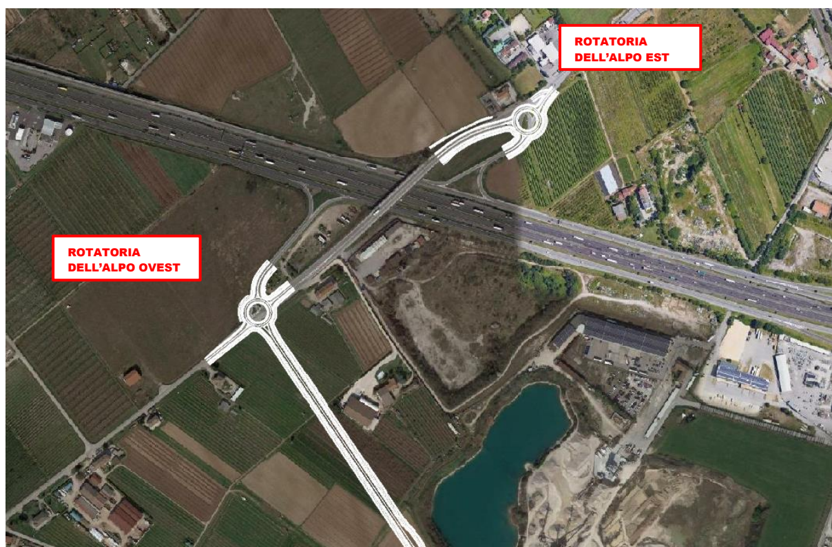
Fig.18-Configurazione di progetto riqualificazione svincolo dell'Alpo
