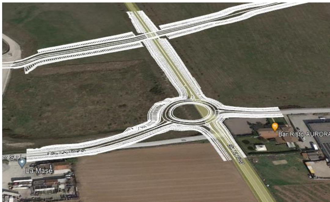
Fig.20-Intersezione Strada La Rizza-via Ca Brusà con rotatoria di progetto
