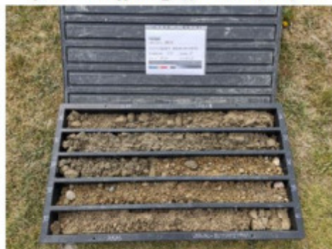
Figura 10 - Sondaggio S37_PZ, profondità 35,00-40,00 m
