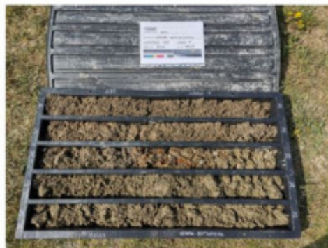
Figura 9 - Sondaggio S37_PZ, profondità 30,00-35,00 m
