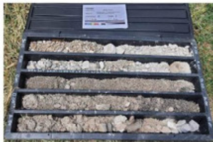
Figura 5 - Sondaggio S12_DH, profondità 10,00-15,00 m
