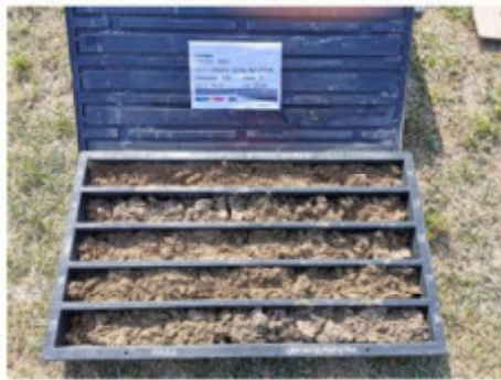
Figura 6 - Sondaggio S37_PZ, profondità 15,00-20,00 m
