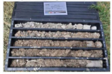
Figura 8 - Sondaggio S12_DH, profondità 25,00-30,00 m
