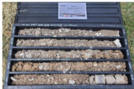
Figura 9 - Sondaggio S12_DH, profondità 30,00-35,00 m
