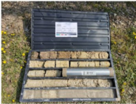
Figura 3 - Sondaggio S37_PZ, profondità 0,00-5,00 m.
