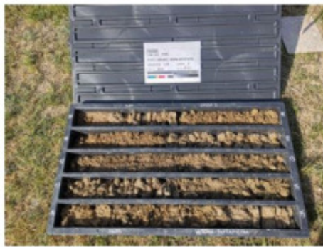
Figura 5 - Sondaggio S37_PZ, profondità 10,00-15,00 m
