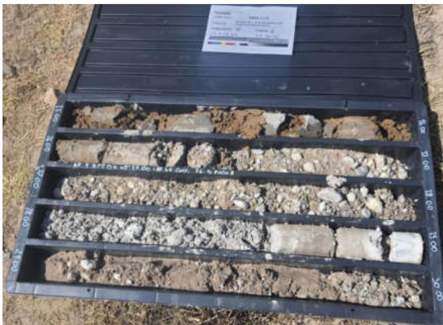
Figura 8 - Sondaggio S28, profondità 25,00-30,00 m
