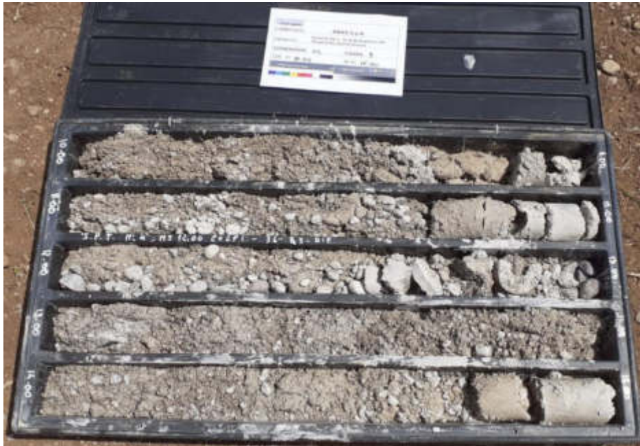
Figura 5 - Sondaggio S04, profondità 10,00-15,00 m
