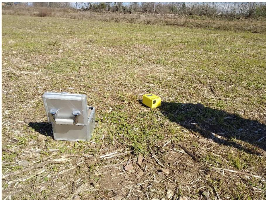
*Figura 8: Foto relativa all'esecuzione della prova HVSR02.*
