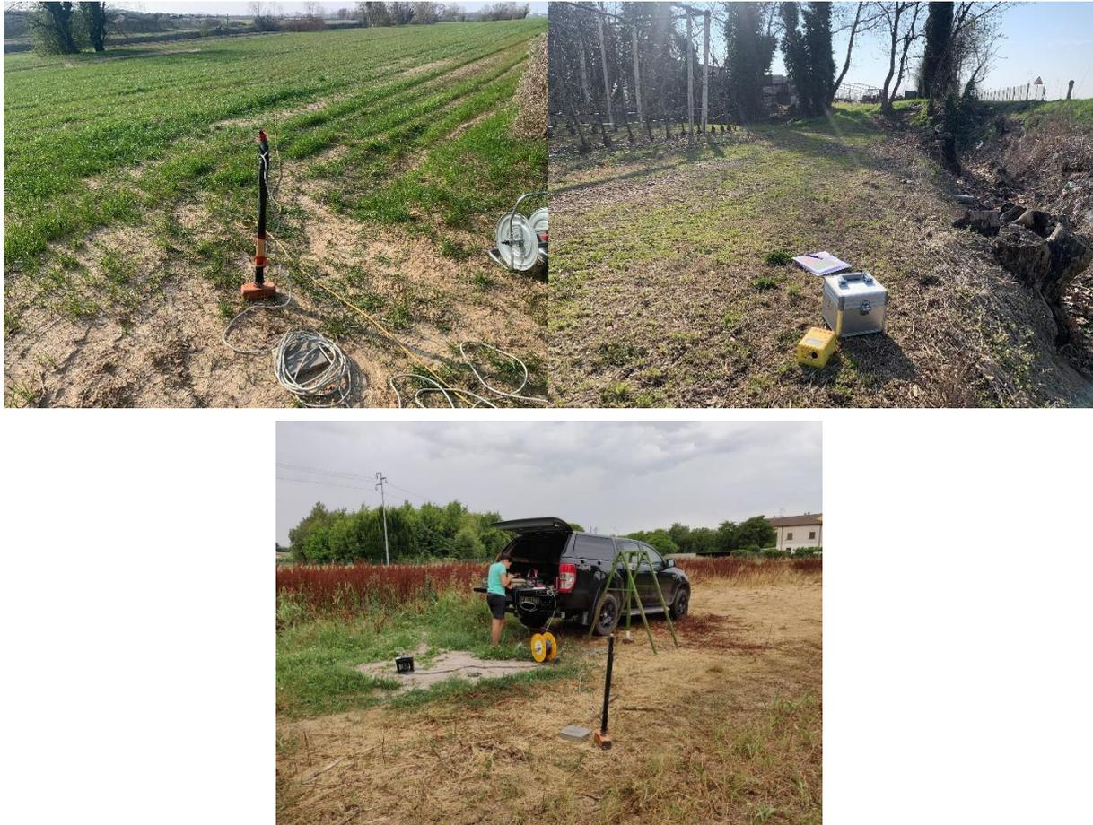
*Figura 1: Strumentazione impiegata per le prove sismiche mediante metodologia MASW (in alto a sinistra), HVSR (in alto a destra) e down-hole (in basso).*
