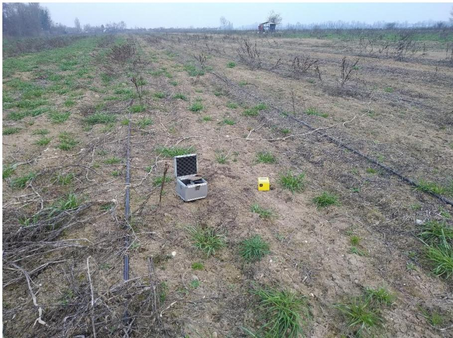
*Figura 10: Foto relativa all'esecuzione della prova HVSR04.*
