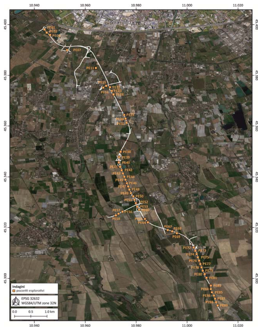
Figura 8. Planimetria con ubicazione dei pozzetti esplorativi realizzato lungo l'infrastruttura viaria.
