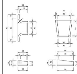
**DETTAGLIO POZZETTO NEI SOTTOPASSI / SOVRAPPASSI**
