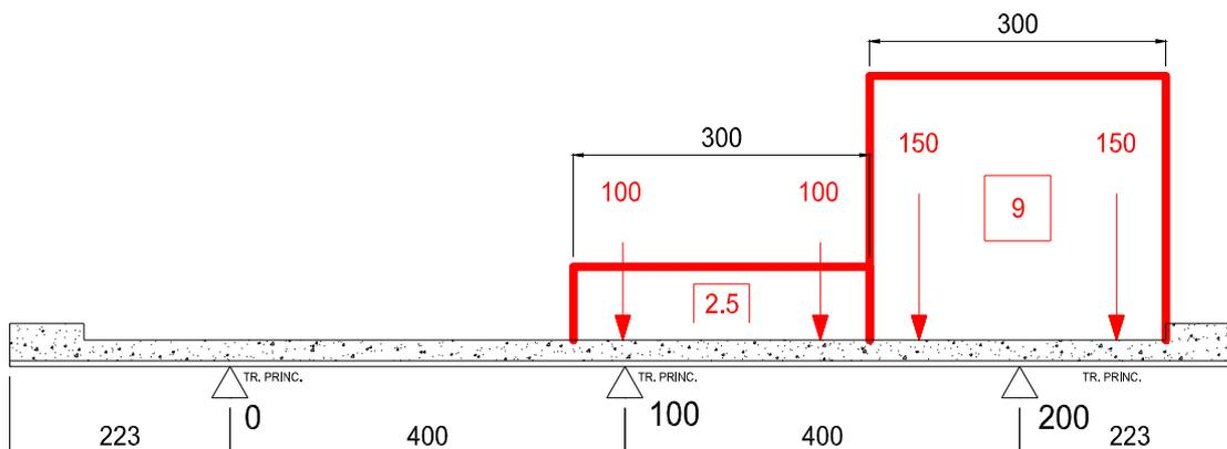
Figura 4.9: Schema di carico – Sezione tipica
