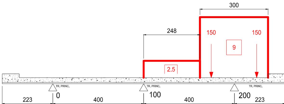
Figura 4.10: Schema di carico – Sezione tipica
