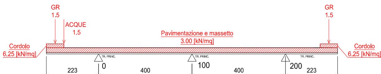
Figura 4.1. Pesì propri portati – Sezione tipica
