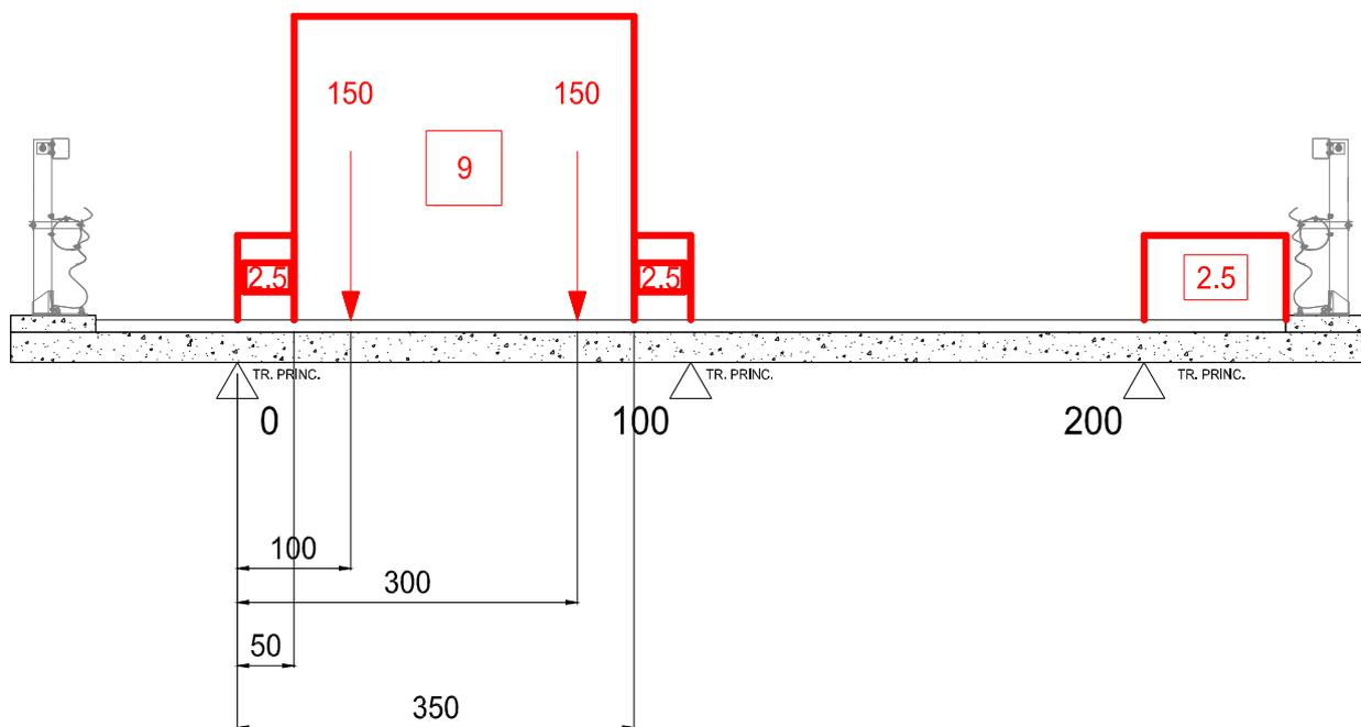
Figura 9-13. Massimo momento positivo in campata - Schema di carico 1
