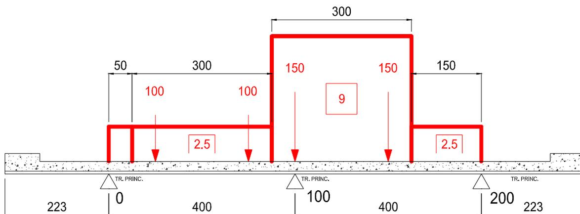
Figura 4.8: Schema di carico – Sezione tipica
