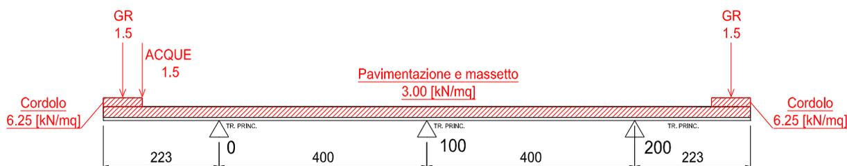
Figura 9-2. Schema di carico fase 2
