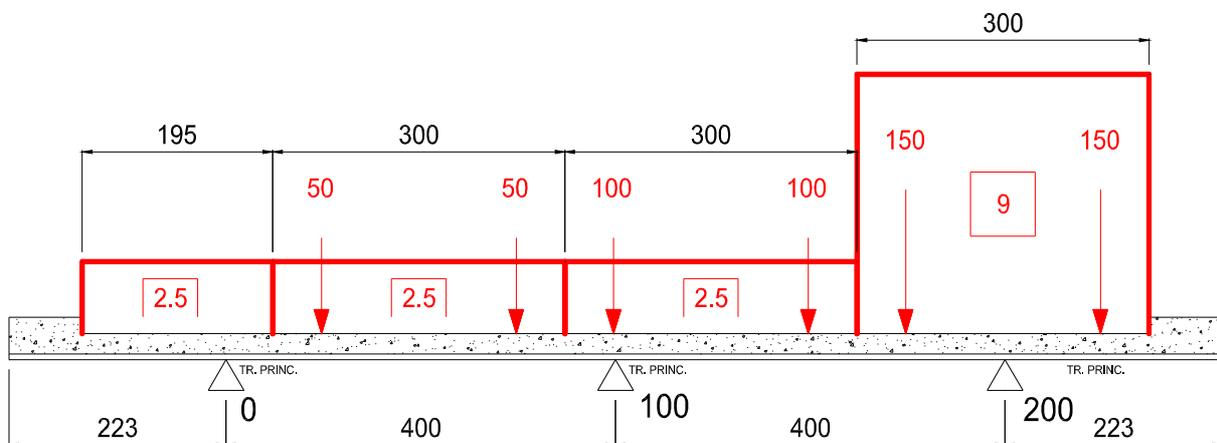
Figura 4.7: Schema di carico – Sezione tipica
