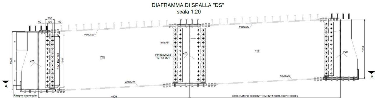
Figure 8-1 Sezione trasversale su diaframmi di spalla
