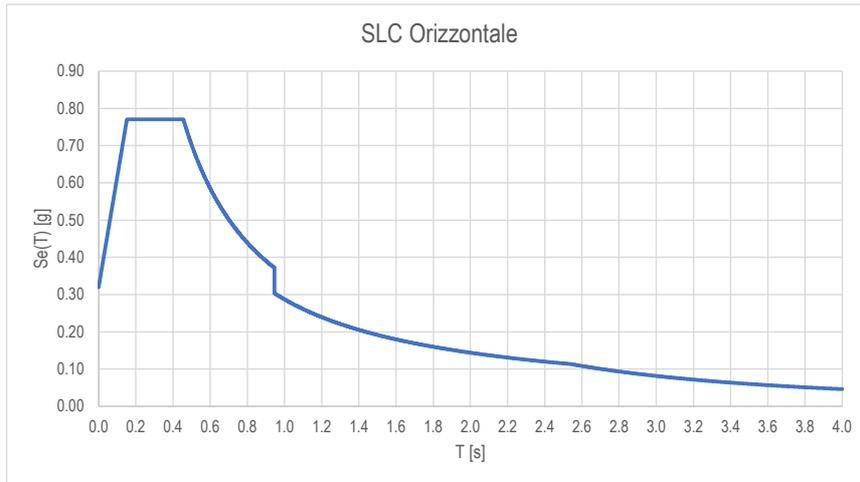
Figura 4.19. Spettro di risposta orizzontale SLC con smorzamento equivalente del 10%
