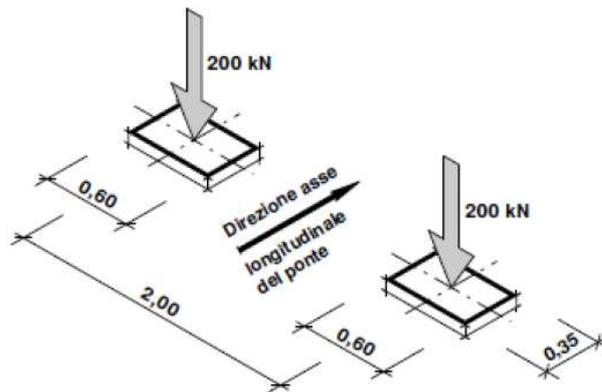
Figura 9.33: Schema di carico 2 (dimensioni espresse in metri)
