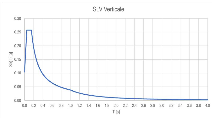
Figura 4.18. Spettro di risposta verticale SLV con smorzamento equivalente del 5%
