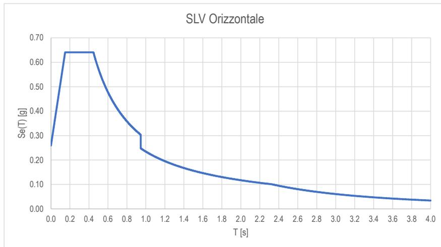
Figura 4.17. Spettro di risposta orizzontale SLV con smorzamento equivalente del 10%
