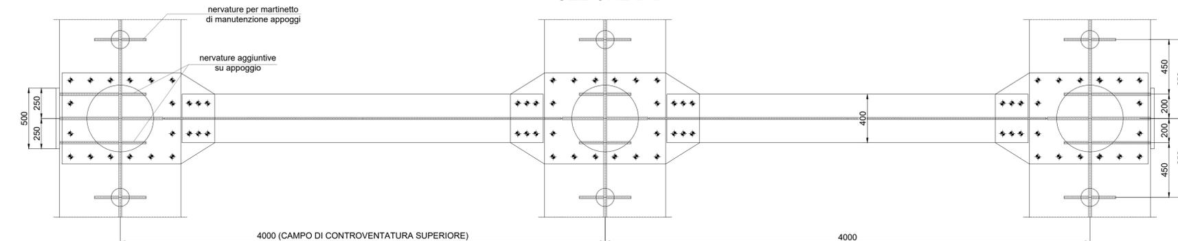
DISPOSIZIONE NERVATURE E FOROMETRIE DA VERIFICARE CON APPOGGI COSTRUTTIVI
