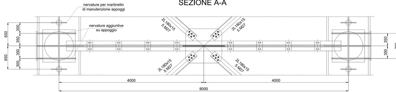
DISPOSIZIONE NERVATURE E FOROMETRIE DA VERIFICARE CON APPOGGI COSTRUTTIVI
