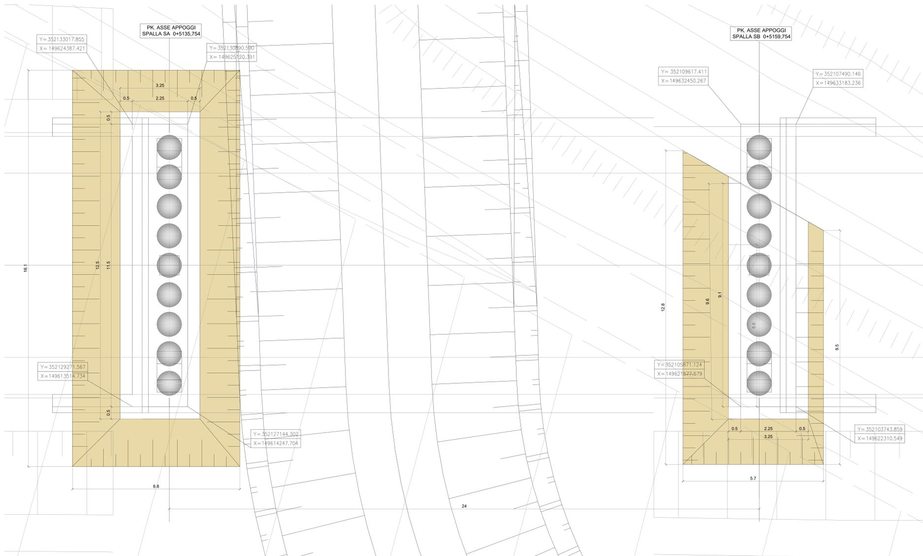
NOTA BENE: PER LA REALIZZAZIONE DELLO SCAVO DI PROFONDITÀ MAGGIORE DI 2 M PREVEDERE UTILIZZO DI WELL POINT PER TUTTA LA DURATA DELLE LAVORAZIONI
