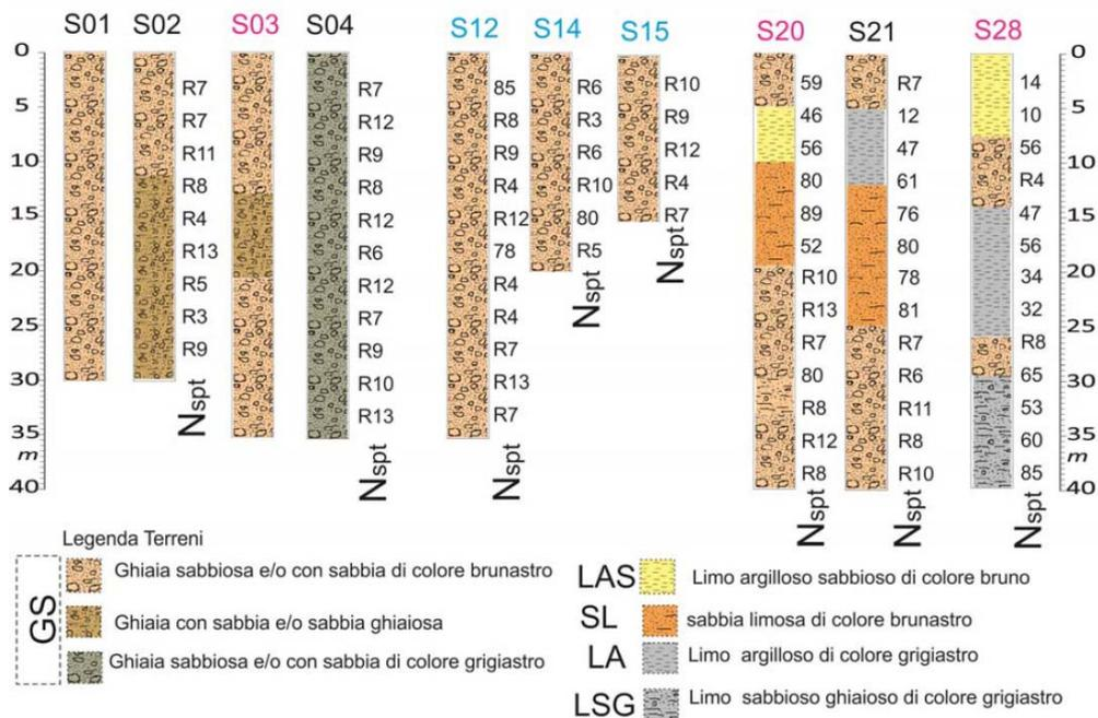
La zona che va dai sondaggi S20 ad S28 è caratterizzata, invece, dalla presenza di materiale coesivo interposto al materiale ghiaioso e sabbioso in profondità.
