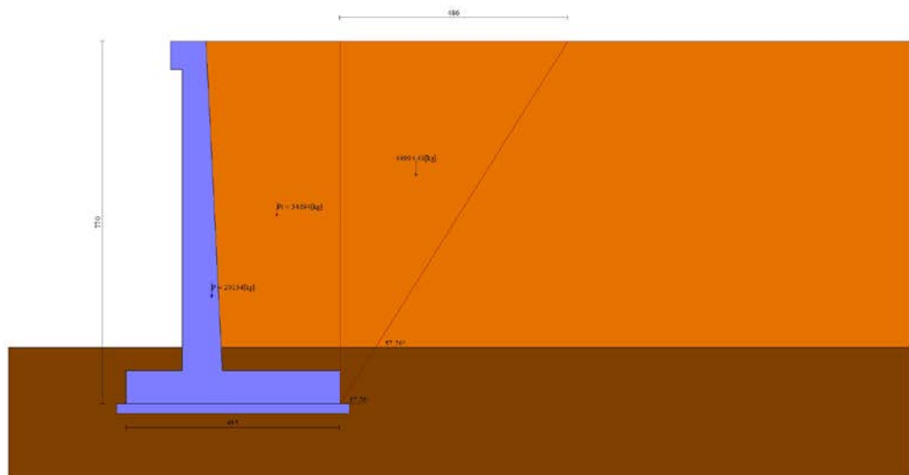
Fig. 3 - Cuneo di spinta (combinazione statica) (Combinazione n° 1)
