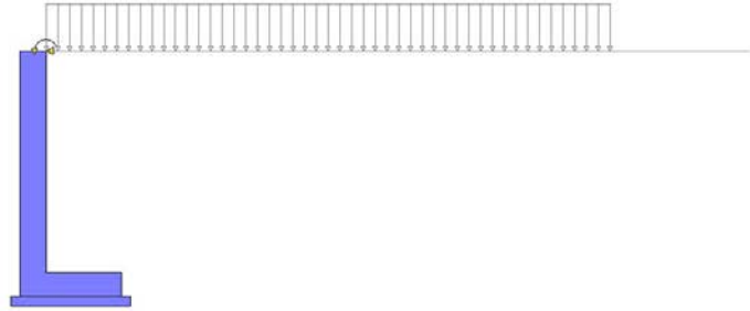
Fig. 3 - Carichi sul muro
