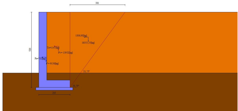
Fig. 3 - Cuneo di spinta (combinazione sismica) (Combinazione n° 2)
