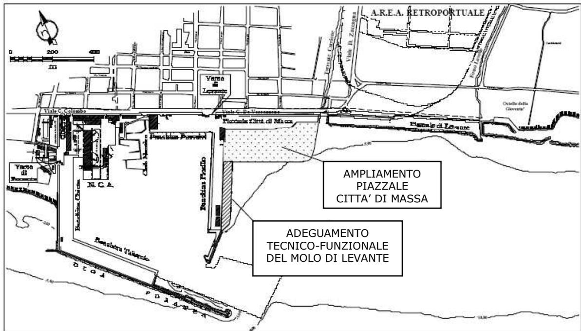
**Figura A3 – Planimetria con individuazione dell'adeguamento tecnico-funzionale del Molo di Levante**
