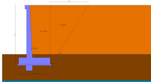
Fig. 1 - Cuneo di spinta (combinazione statica) (Combinazione n° 1)
