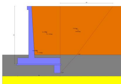
Fig. 3 - Cuneo di spinta (combinazione sismica) (Combinazione n° 2)
