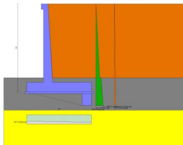
Fig. 4 - Diagramma delle pressioni (combinazione sismica) (Combinazione n° 2)
