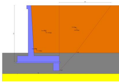
Fig. 3 - Cuneo di spinta (combinazione sismica) (Combinazione n° 2)
