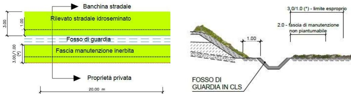
Figura 7.8 – Griglia e Prospetto modulo PI-RI RIL 1
