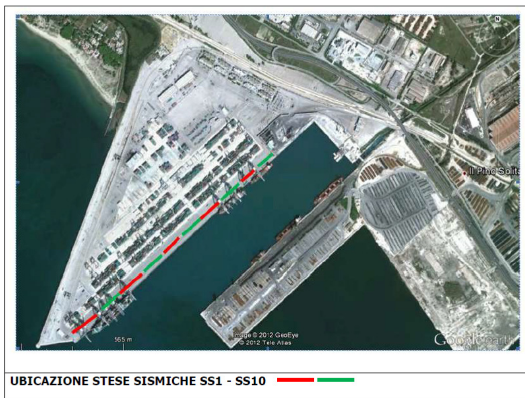
Figura 5 Ubicazione degli stendimenti sismici effettuati nel mese di giugno 2012
