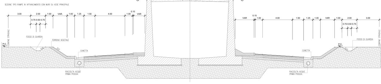
DETTAGLIO MARGINE IN RILEVATO
