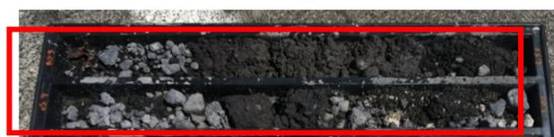
Figura 22 Sondaggio RS1 – 1) campione da -4,5 a -10 metri
