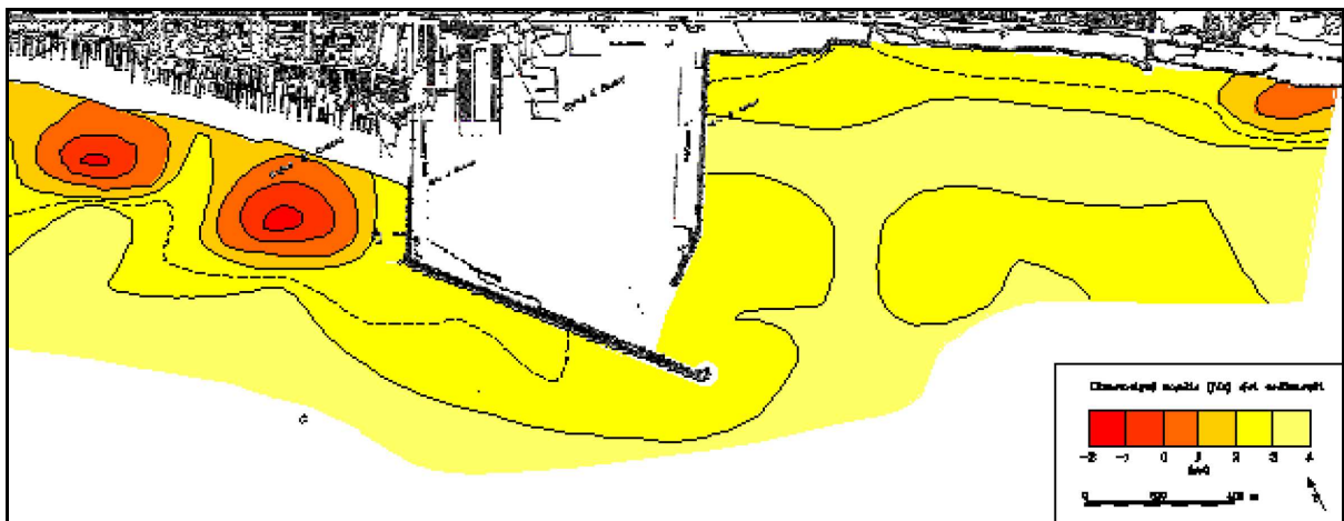
Figura C112 – Rappresentazione grafica delle dimensioni medie dei sedimenti nell'intorno del porto
