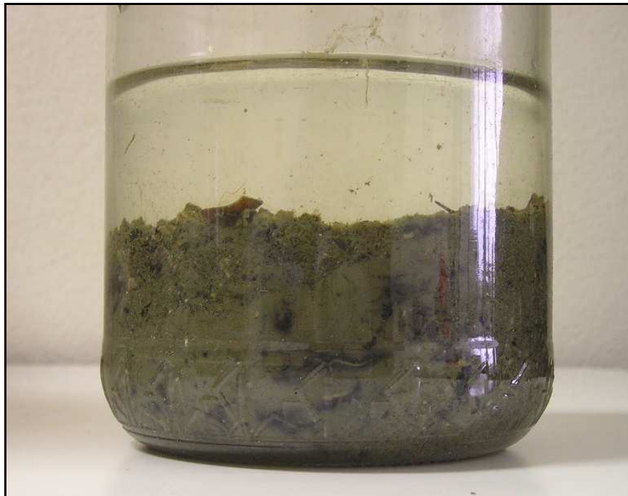
Figura C139 - Campione di fondale prelevato a circa 80 m dal molo di levante. Si evidenzia la stratificazione tra fango e sabbia e la diminuzione della matrice organica.
