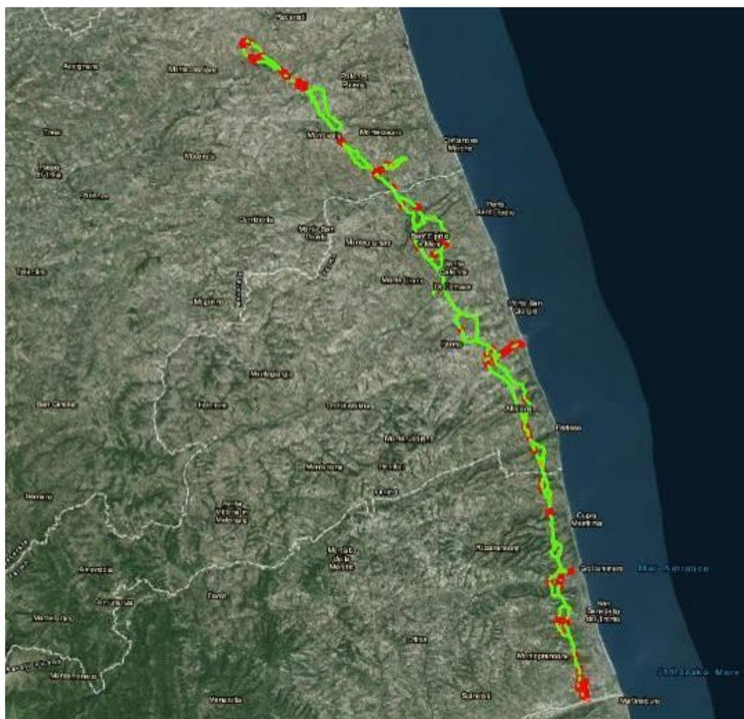
Figura 4-1: Carta del rischio di contaminazione del suolo e sottosuolo lungo i tracciati dei metanodotti.
