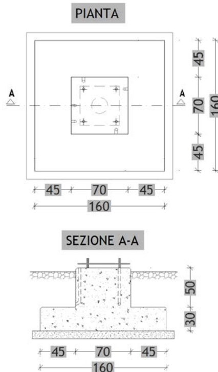
Fig. Pianta e sezione fondazione per scaricatore AT
