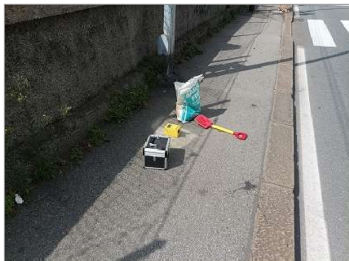
Foto 12: prova sismica passiva S_p (12).
