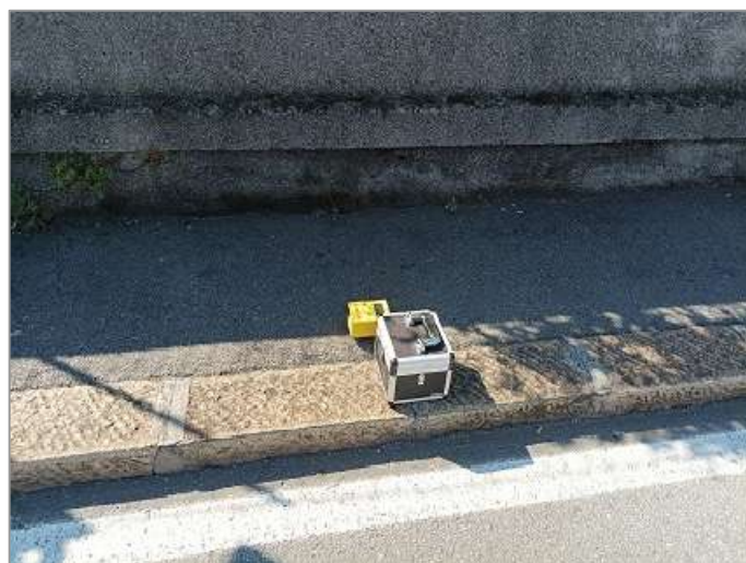
Foto 14: prova sismica passiva S_p (14).
