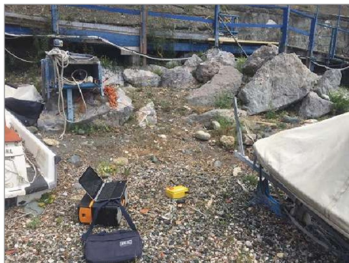
Foto 8: prova sismica passiva S_p (8).
