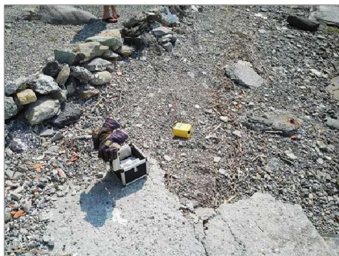
Foto 6: prova sismica passiva S_p (6).
