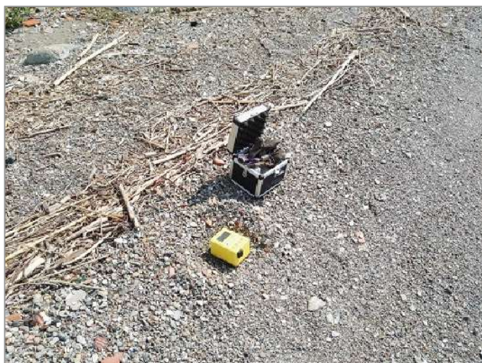
Foto 1: prova sismica passiva S_p (1).
