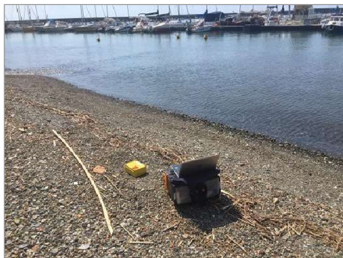
Foto 4: prova sismica passiva S_p (4).
