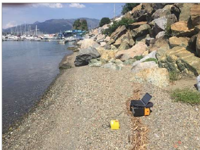
Foto 5: prova sismica passiva S_p (5).
