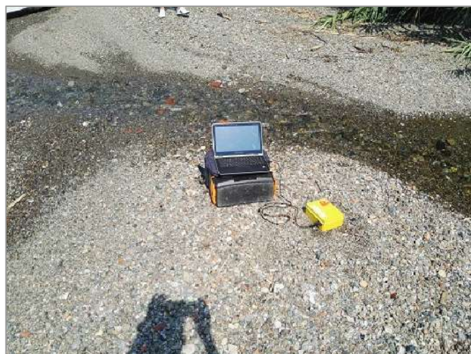
Foto 2: prova sismica passiva S_p (2).
