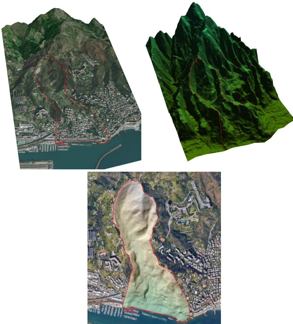
Figura 24 – Modello digitale3D del terreno (DTM) a maglia 5.0[m]x5.0[m] approntato per le analisi a scala di bacino
