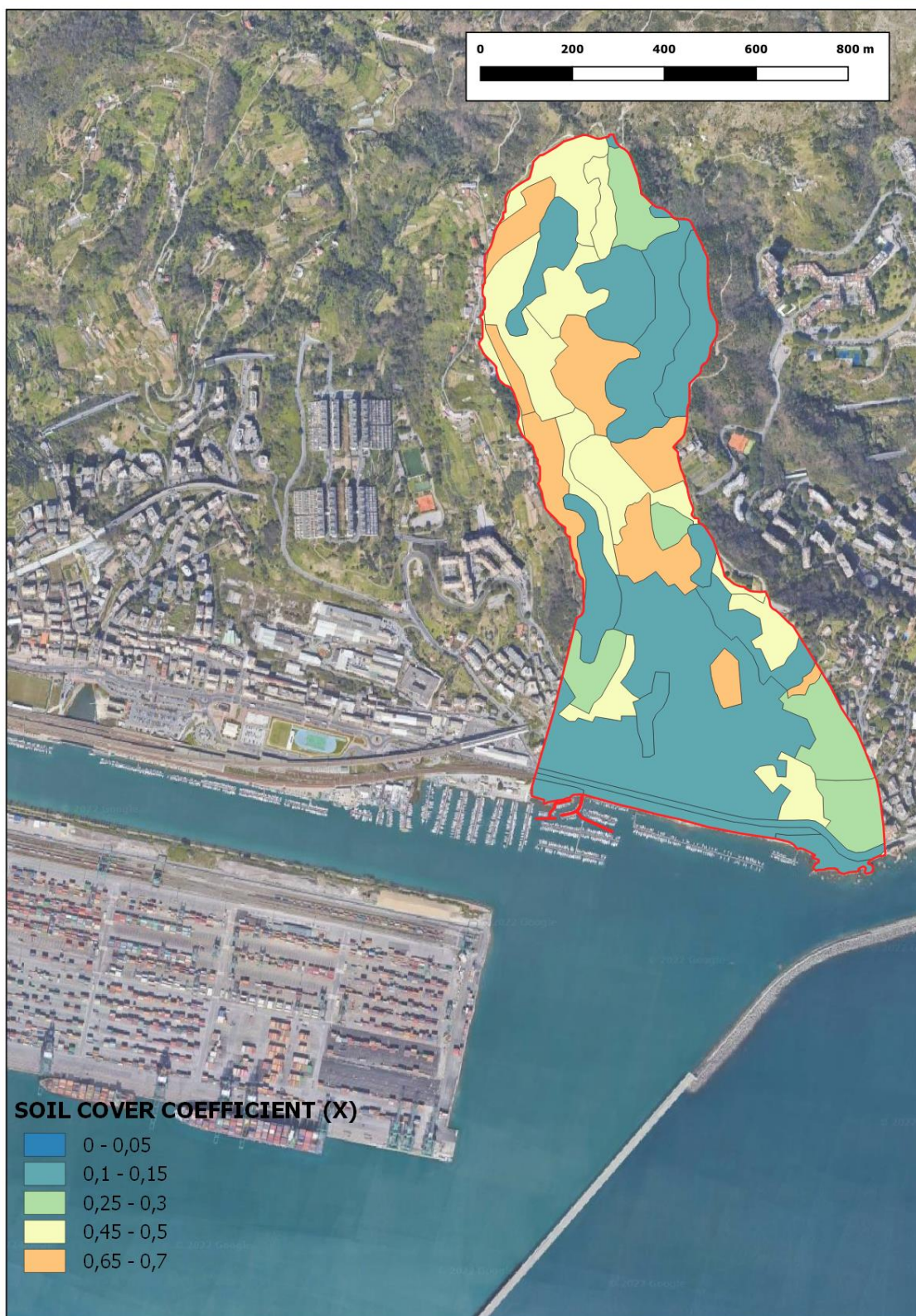
Figura 74 – Bacino del rio Grillè – EPM – Coefficiente di copertura del suolo (X) – Valori medi
