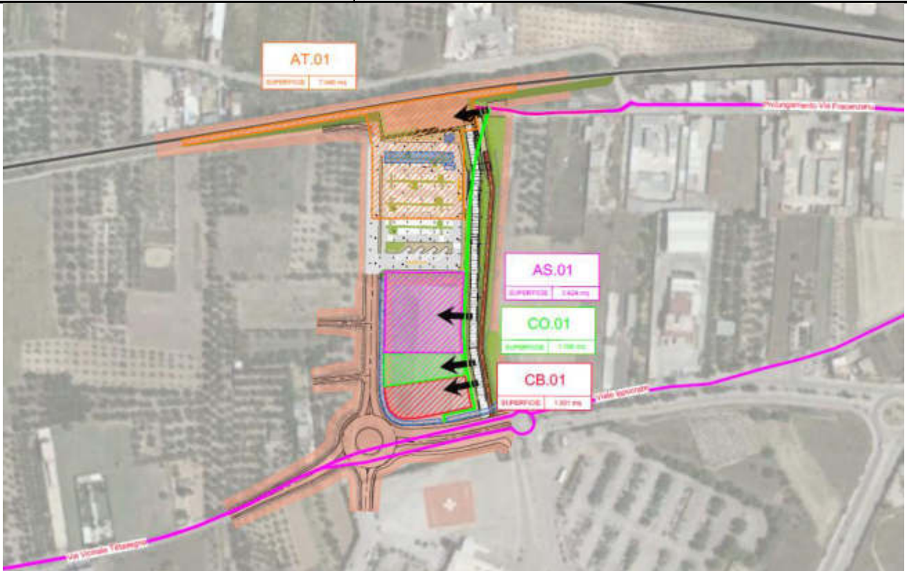
Figura 15 – Planimetria dei cantieri e viabilità di accesso alle aree di cantiere (in verde pista di cantiere)
