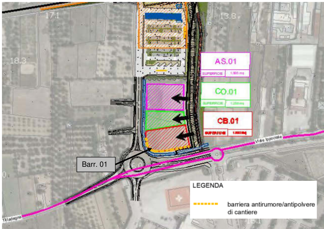
Figura 65 Ubicazione planimetrica della barriera antirumore/antipolvere di cantiere
