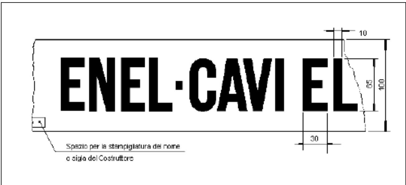
Figura 8 – Nastro di segnalazione
