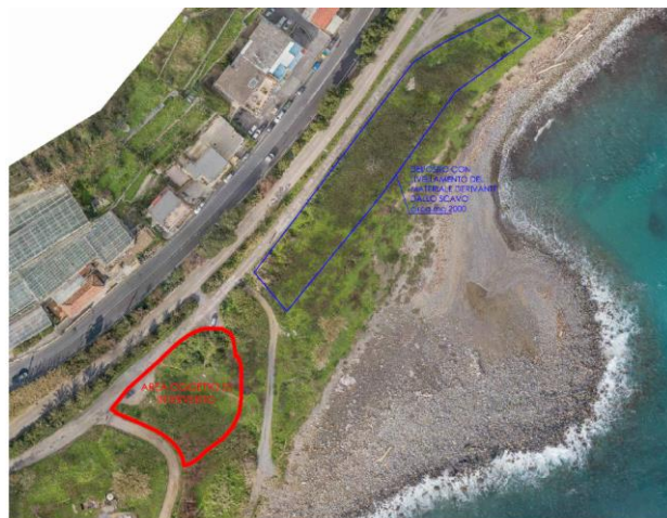
INDIVIDUAZIONE DELL'AREA D'INTERVENTO E DEL SITO DI DEPOSITO DEL MATERIALE DERIVANTE DALLO SCAVO Deposito con livellamento di circa 278 mc su circa 2000 mq (spessore medio 13/14 cm)
