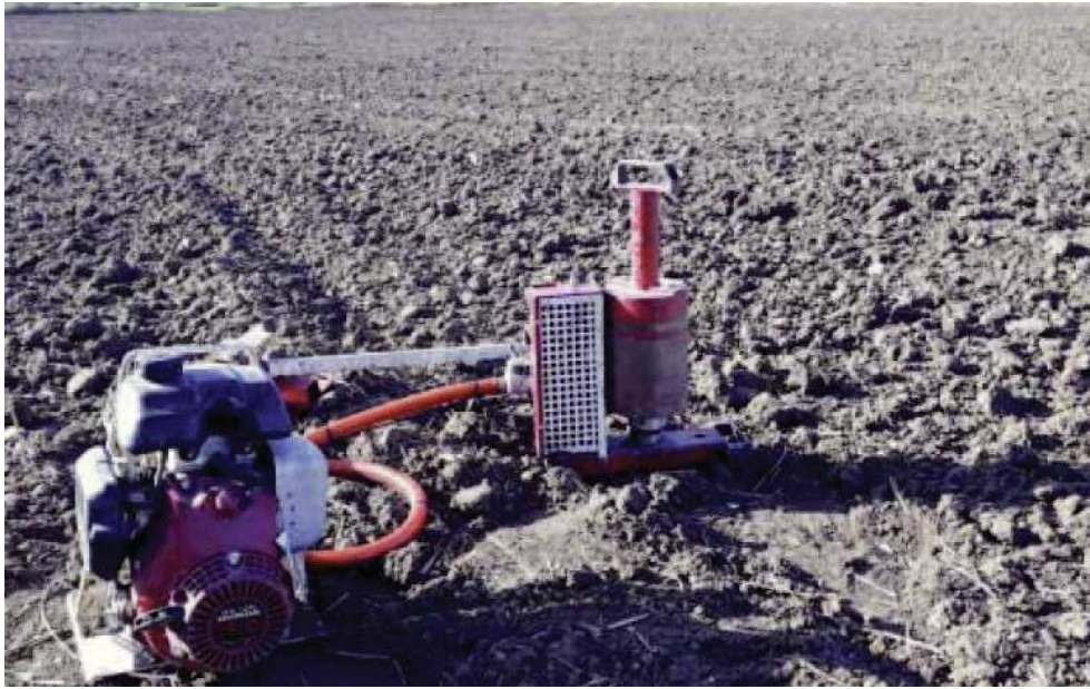
Particolare penetrometro dinamico
