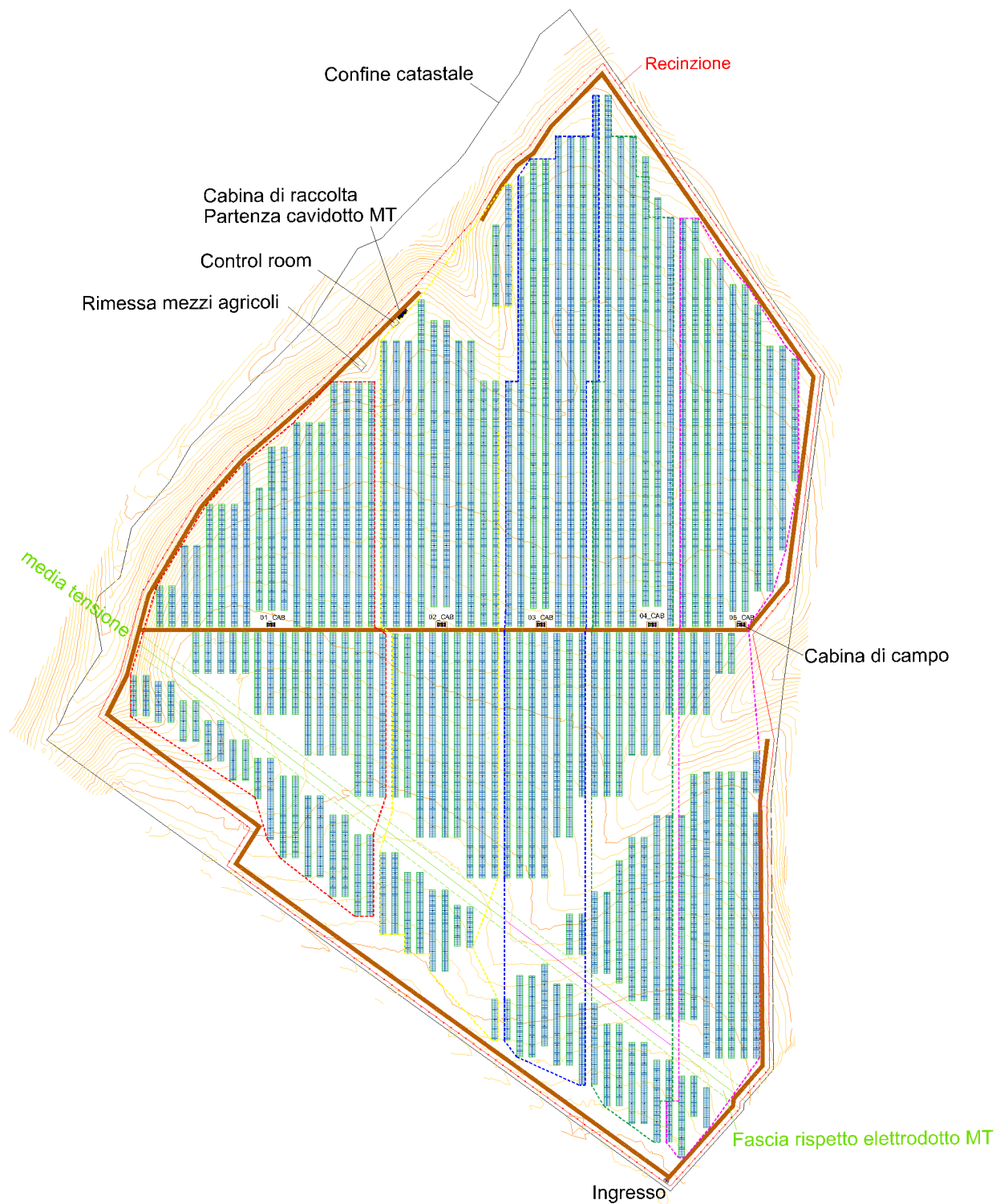
Figura 6.8 – Layout dell'impianto fotovoltaico
